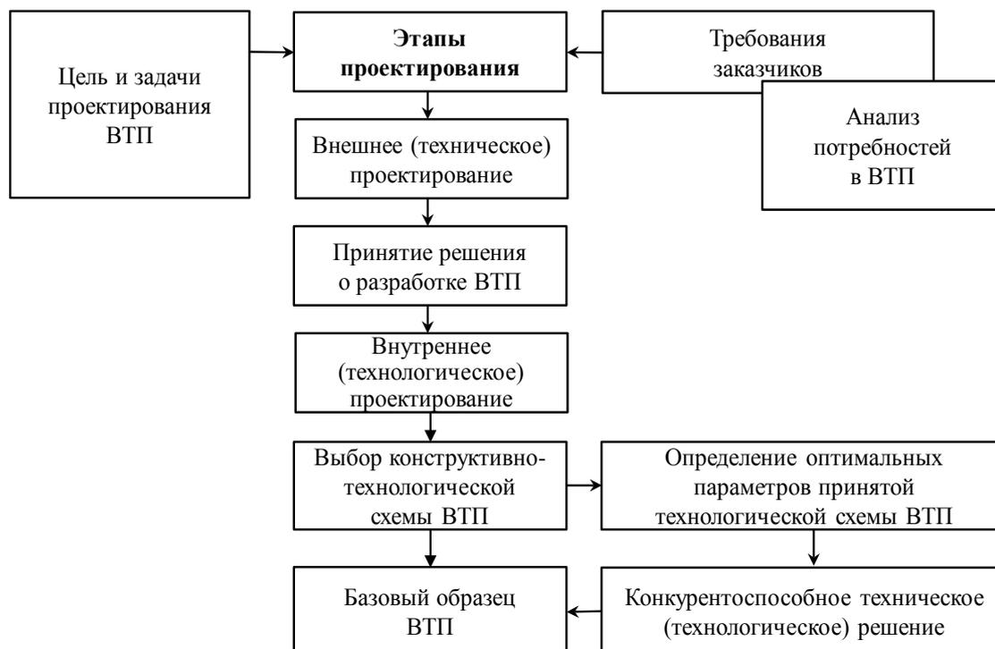
Рис. 3. Комплексная модель системного проектирования высокотехнологичной продукции
